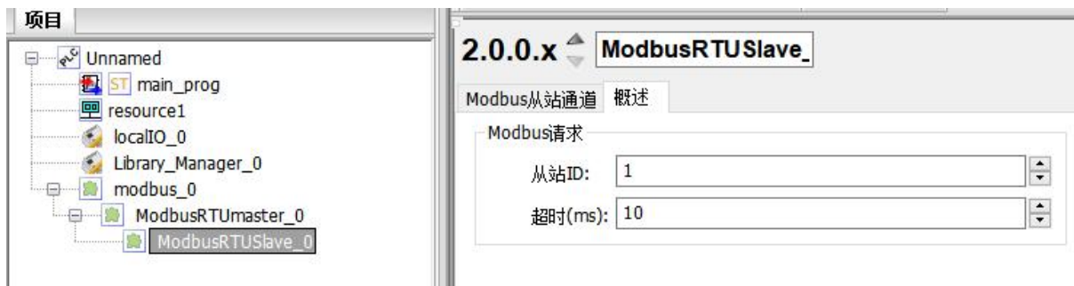
图 6-15 ModbusRTUSlave 从站概述配置
