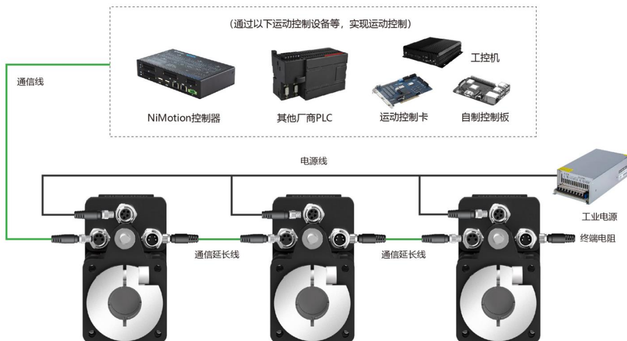
图 3-5 组网接线图（CANopen&RS485）
