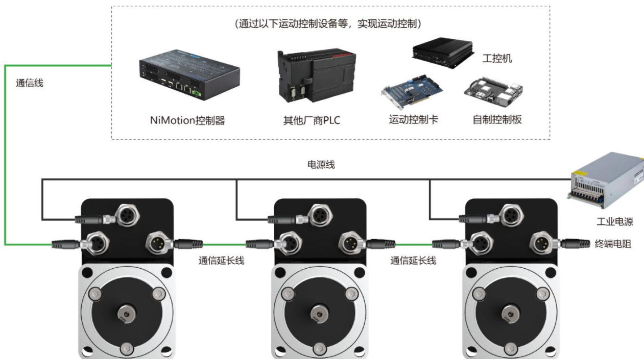
图 3-5 组网接线图 (CANopen&RS485)
