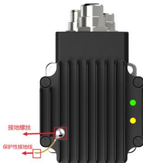
图 3-3 PSMP60 系列外壳保护性接地示意图
