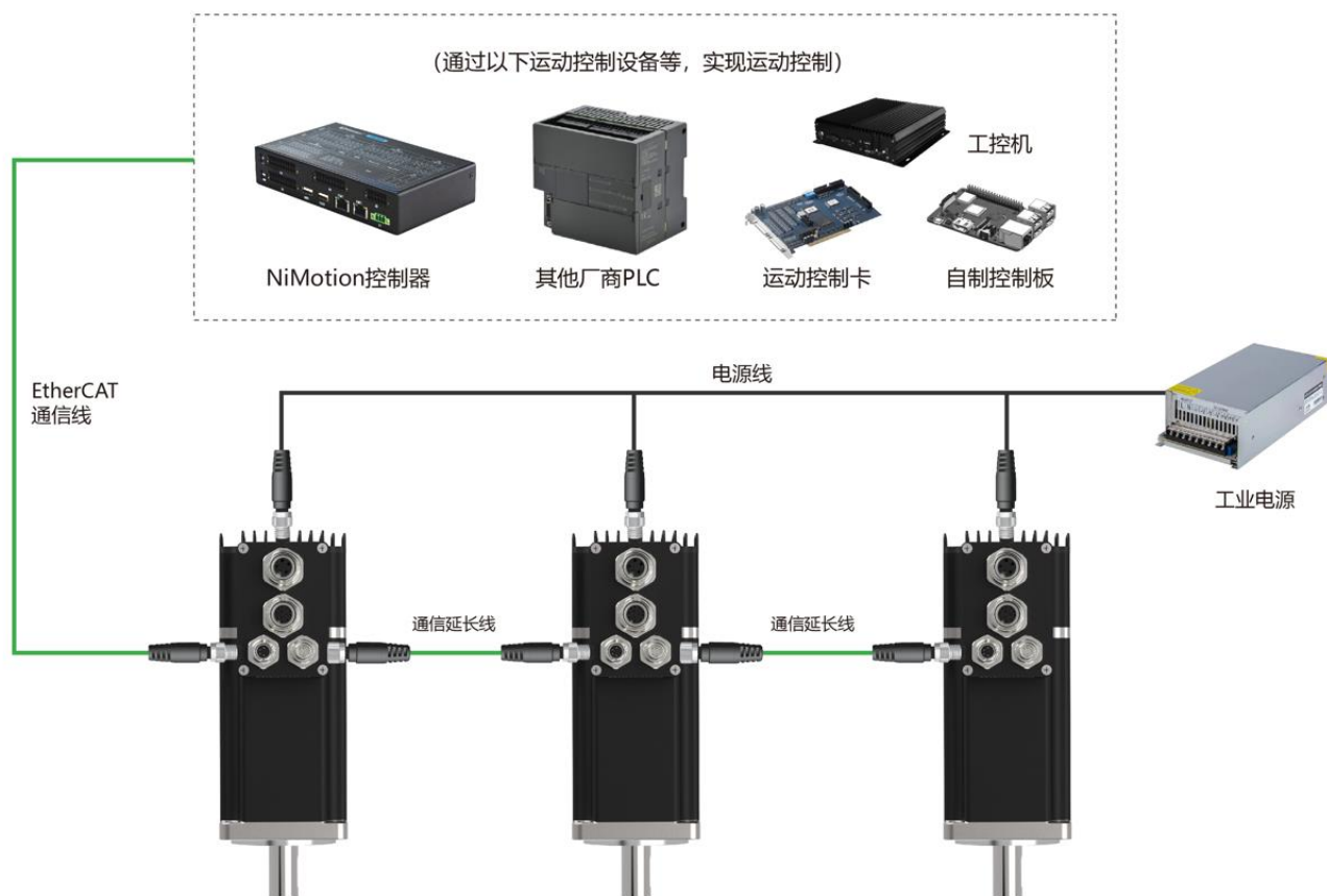
图 4-9 EtherCAT 通信组网接线图
