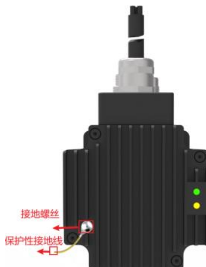
图 3-6 PSMP80 系列外壳保护性接地示意图
