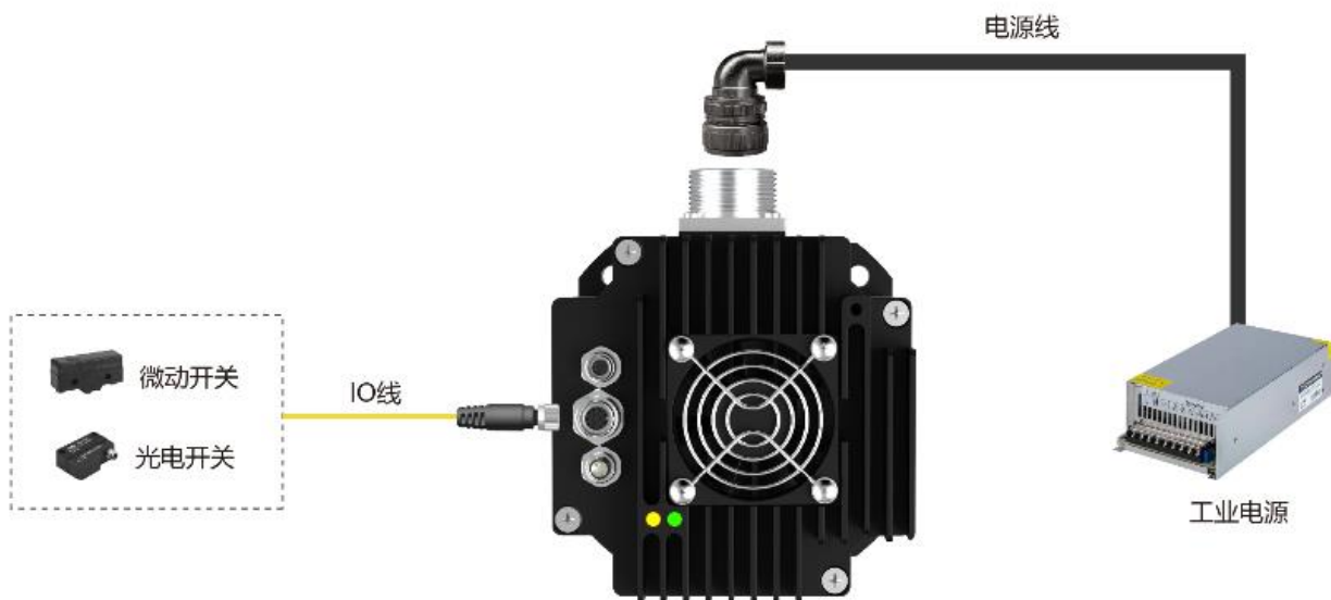
图 4-7 外部控制接线图
