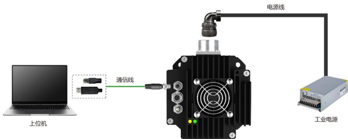
图 4-4 一体化电机调试接线图
