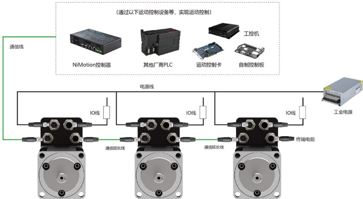
图 4-8 组网拓扑图 (CANopen&RS485)
