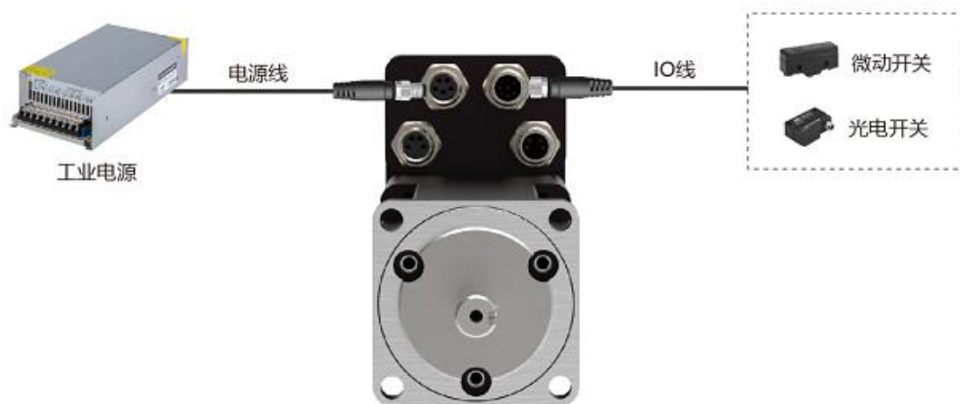
图 4-7 外部控制接线图（传感器通过 IO 端口控制）
