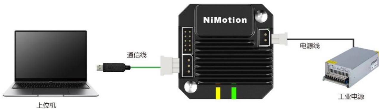
图 21 一体化电机调试接线图
