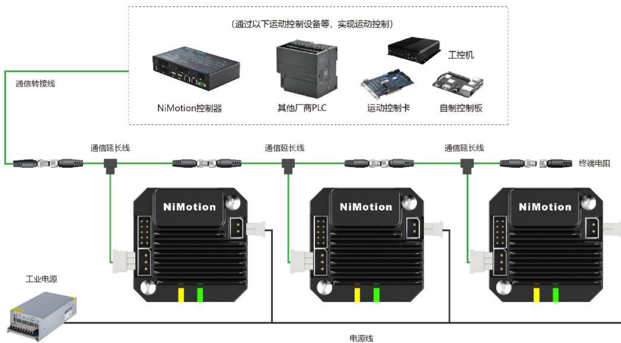
图 23 组网接线图（CANopen&RS485）
