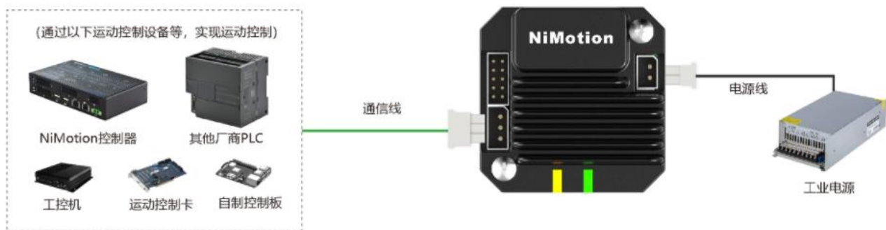
图 20 外部控制接线图（通过通信总线控制）
