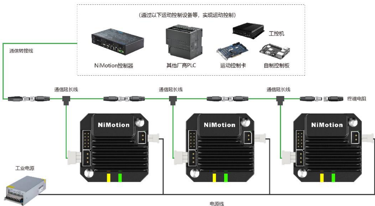
图 21 组网接线图（CANopen）
