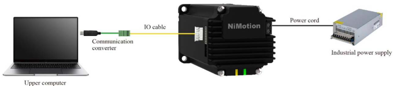
图 15 一体化电机调试接线图
