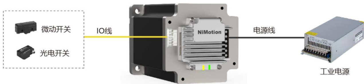
图 3-6 外部控制接线图
