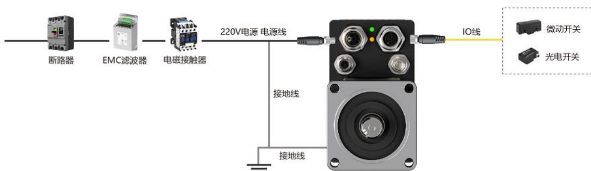
图 4-7 外部控制接线图
