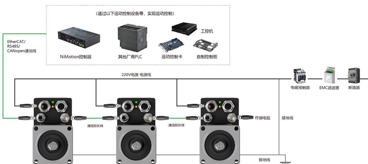
图 4-8 通信组网接线图
