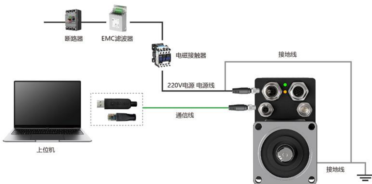
图 4-4 一体化电机调试接线图
