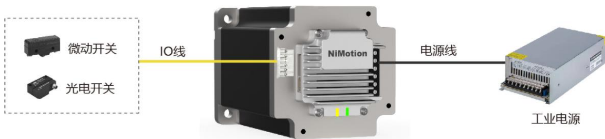
图 4-5 外部控制接线图
