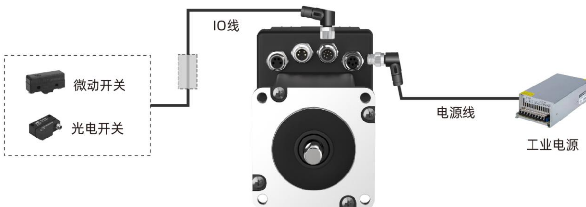
图 4-6 外部控制接线图
