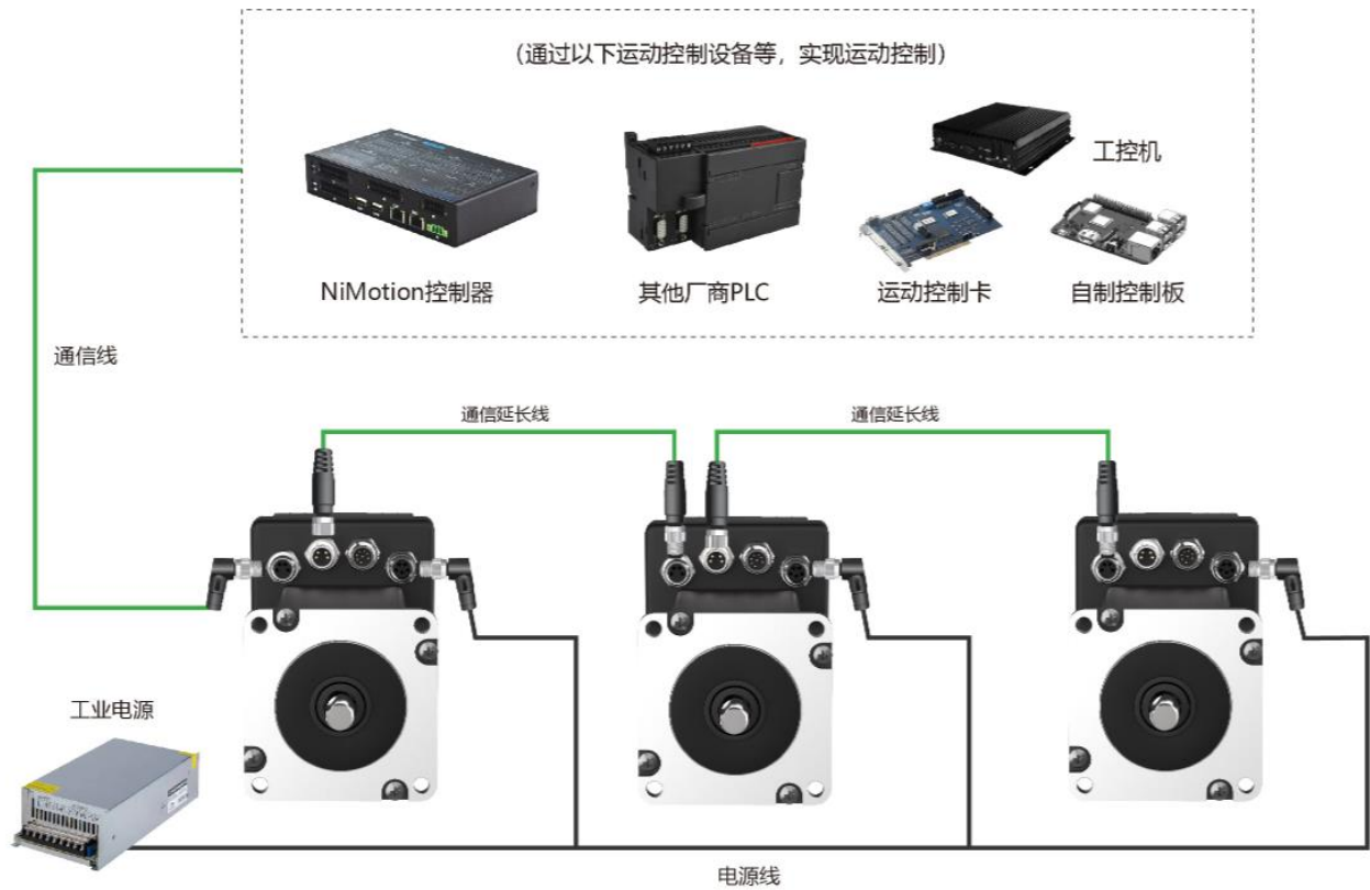
图 4-7 通信组网接线图
