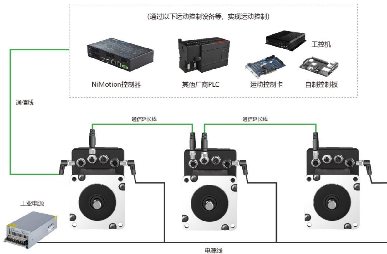
图 4-7 RS485&CANopen 通信组网接线图
