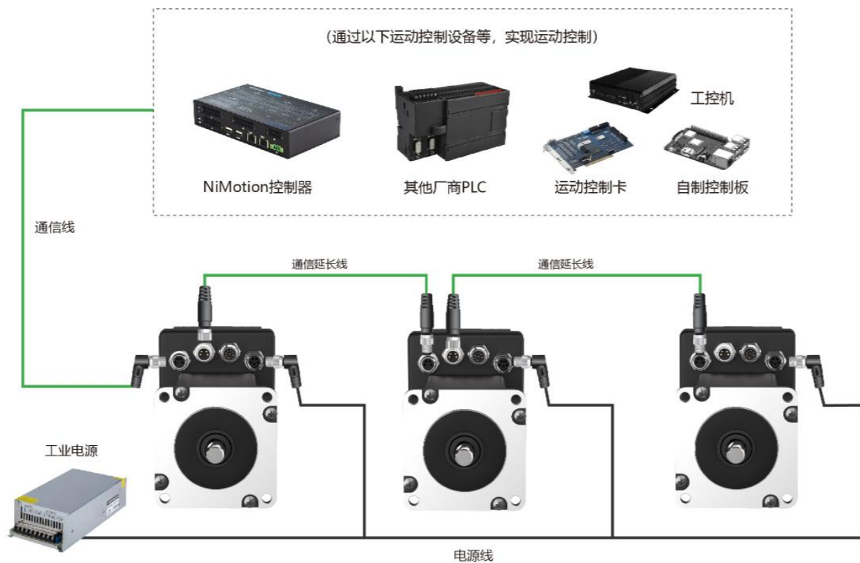
图 4-7 RS485&CANopen 通信组网接线图
