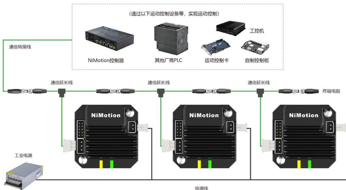
图 3-7 RS485&CANopen 通信组网接线图
